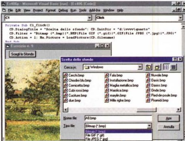
Figura 11 - Visual Basic 5.0 - Finestra File Apri e lettura di un file grafico. La finestra File Apri è un servizio di Windows facilmente utilizzabile, grazie al controllo Common Dialog Box che ne rende immediato (due o tre istruzioni) lo sfruttamento. Qui lo usiamo, dopo averlo opportunamente personalizzato, per permettere all'utente dell'applicazione di scegliere il file di tipo grafico da usare come sfondo (proprietà Picture) del Form. Si tratta del primo e più semplice esempio di utilizzo di un file grafico con VB.
